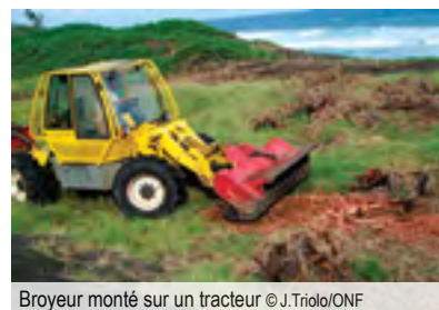
Broyeur monté sur un tracteur © J.Triolo/ONF
